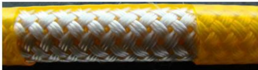
Triple Weave Yarn Structure 三重编织的纱线结构
